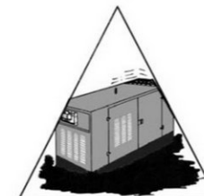
Слишком неровный или рыхлый грунт → Неверная установка агрегата
